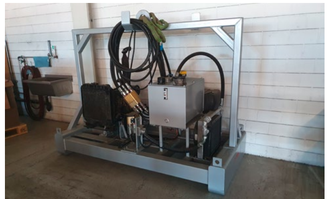
Groupe électrogène diesel pour enrouleur et dérouleur en cas de fonctionnement autonome
