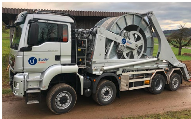
Verlege-Fahrzeug mit Welaki-System (8 × 6)
