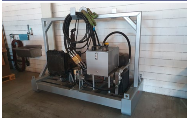
Diesel Aggregat für Auf- und Abrollvorrichtung bei Autonombetrieb
