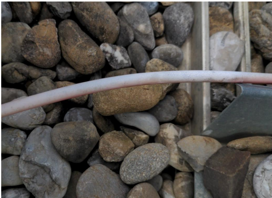
Décoloration des câbles solaires (colorés), le rouge en particulier se décolore très rapidement (source : Robert Kröni)
