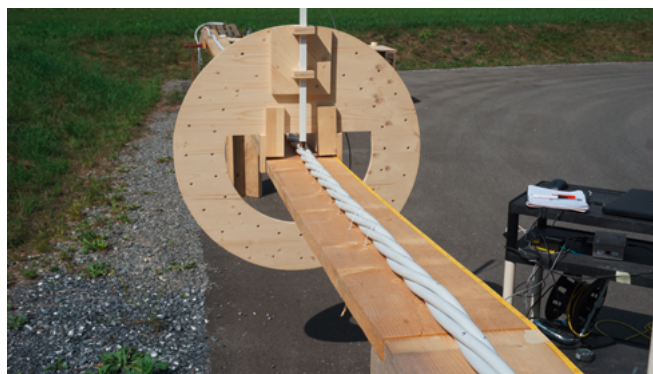
20 Meter langer Messtisch mit Teilungsapparat zur Messung der Magnetfelder im Nah- und Fernbereich.
