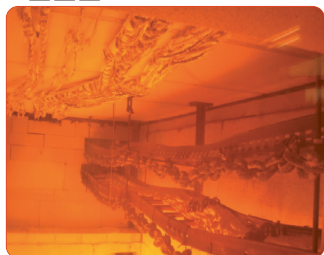
Le câble et le chemin de câble sont testés ensemble lors de la simulation d'un grand incendie (four).
