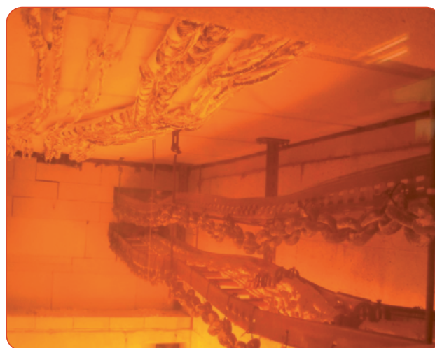
I cavi e sistemi di posa sono testati insieme durante la simulazione di un grande incendio (forno).
