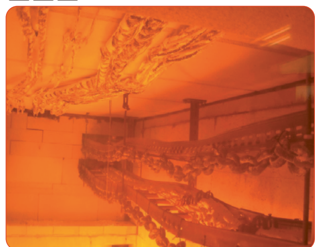
Kabel und Verlegesystem wurden zusammen während der Simulation eines grossen Brandes (Brandofen) getestet.
